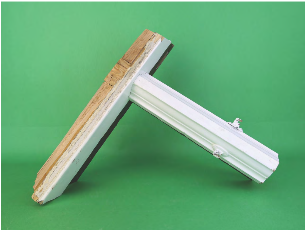
Fig. 2. Fotogrammetrisk skanning för att skapa en sluten digital modell. Fotografering av fönsterkarm mot greenscreen.
